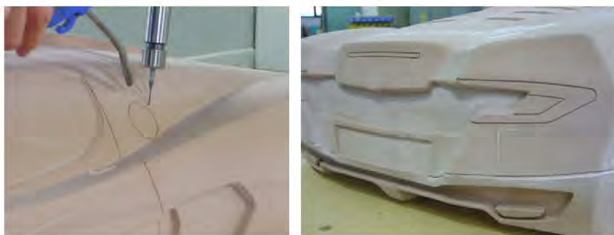
Figura 9.2.5 – realizzazione delle tracciature
