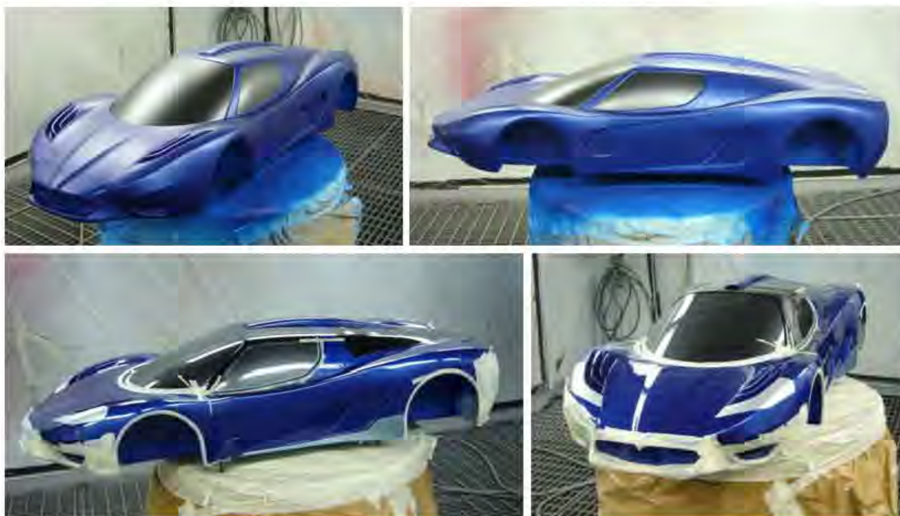
Figura 9.2.7 – fasi relative alla verniciatura
