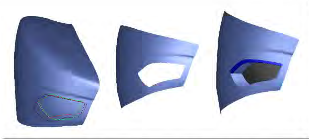
Figura 7.3.15 – Fasi relative alla creazione della presa d'aria inferiore
