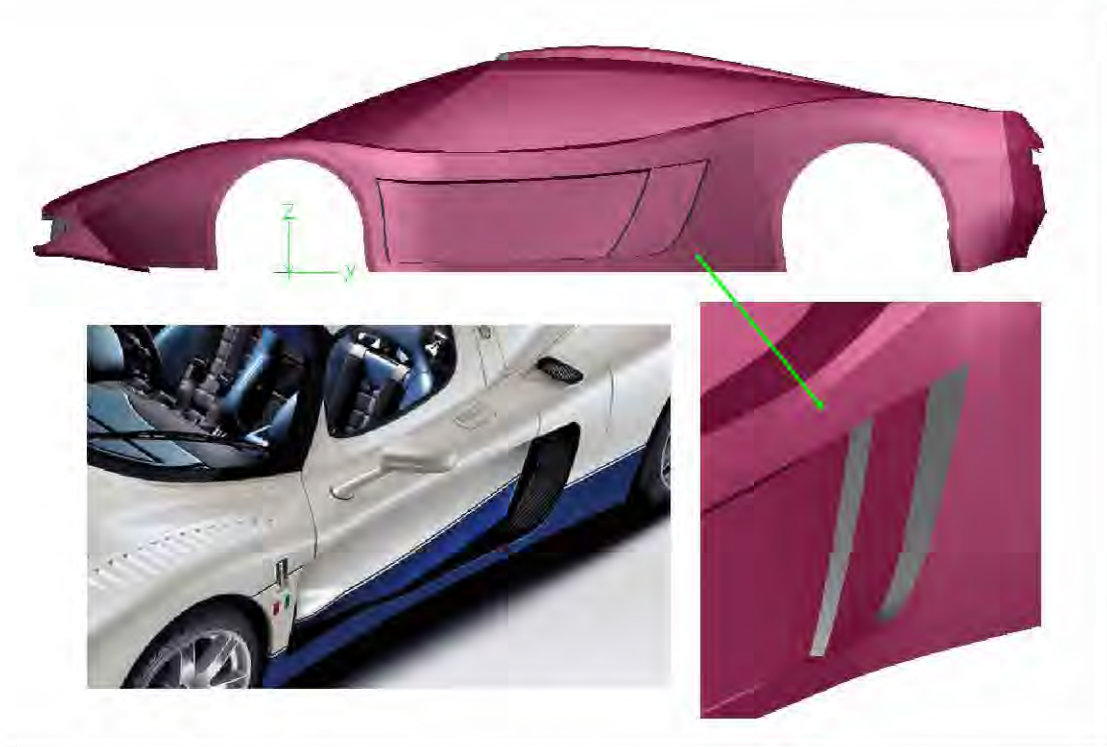
Figura 7.4.8 – fianco; particolari relativi alla presa d'aria laterale, MC12 originale e modello matematico
