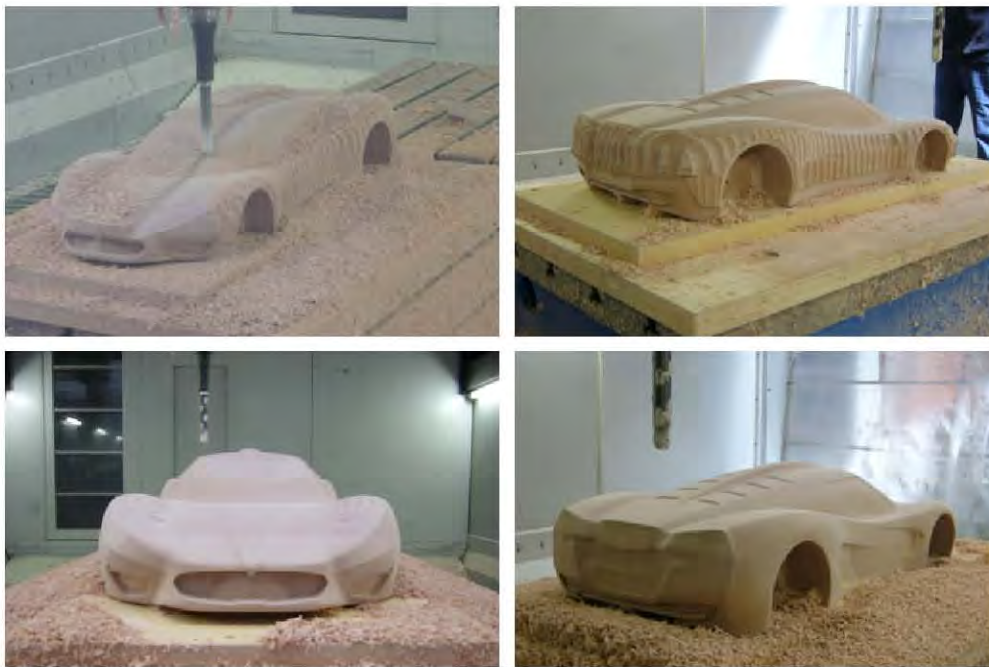
Figura 9.2.3 – ulteriore sgrossatura e finitura
