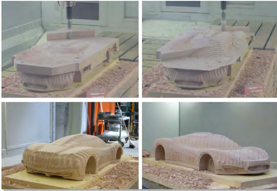
Figura 9.2.2 – fasi di sgrossatura e risultato ottenuto
